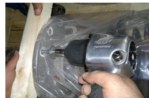
شکل ۸ استفاده از پیچ‌های خودکار برای محکم نمودن فلنج بوشینگ به جعبه حمل
