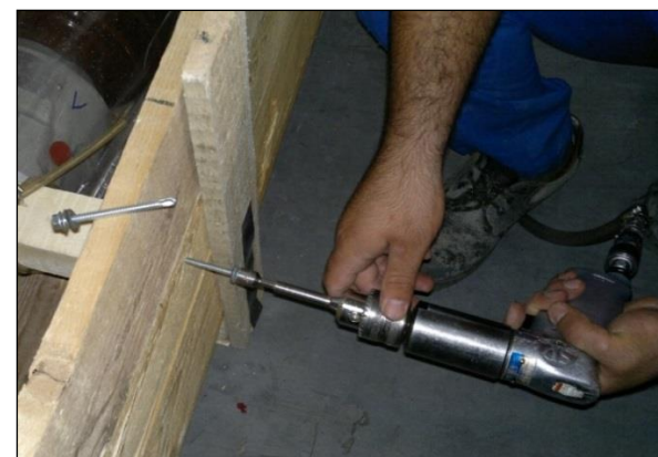
شکل ۱۲ روش صحیح باز کردن در جعبه حمل یا جدا نمودن ساپورت‌ها
