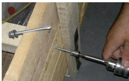
شکل ۷ استفاده از پیچ‌های خودکار برای اتصال قطعات چوبی جعبه حمل
