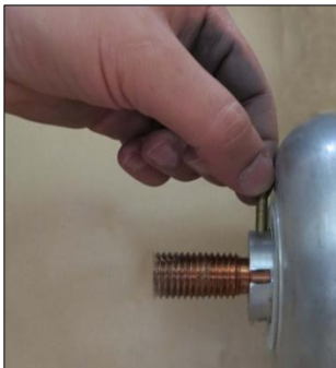
شکل ۲۰ خارج کردن پين نگهدارنده
