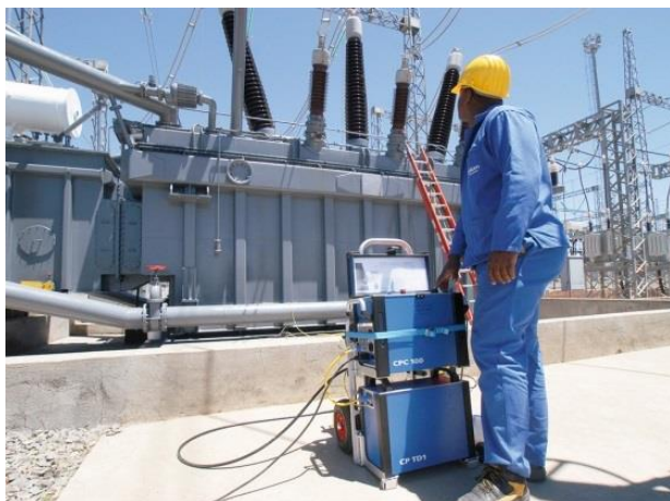
شکل ۳۷ تست‌های الکتریکی روی بوشینگ در محل پست با استفاده از دستگاه مخصوص Fig. 37 On-site electrical measurements of bushing by special equipment
