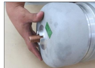
شکل ۲۱ باز کردن درپوش آلومينيومی فوقانی
