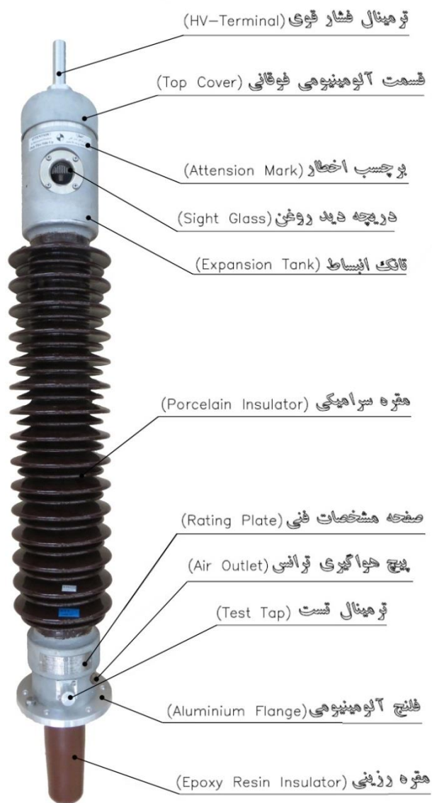
شکل ۳ تصویری از پوشینگ (مدل NGB1) به همراه معرفی بخش‌های مختلف آن
